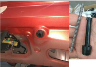
1.6 拆下原车上锁头两侧的缓冲装置，拔除橡胶垫块连杆和内置弹簧后，装回原孔位，如图。
