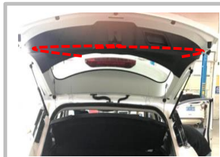
3.1 ECU 上置，左右撑杆线走线图，
