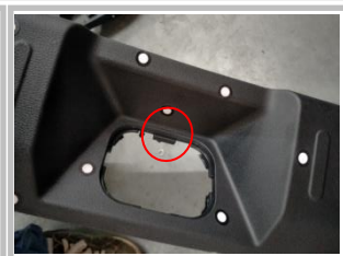
1.9 大后踏盖割胶；将标记内凸起位置割割到与斜面平齐即可；具体割胶量以实际试车为准。
