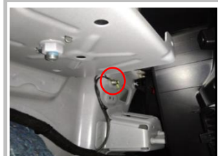
3.4 ECU 负极，尾箱左侧，座椅固定扣上方
