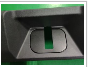
1.11 安装小后踏盖：大后踏盖割胶完成后安装上小后踏盖，图示为已经安装完成
