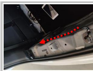
1.8 驱动盒以及拉线布置完成，如图所示，注意：内饰板等插线后再还原
