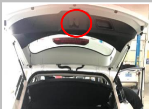
3.9 门锁信号线，找到原车上门锁插头，使用配套转接线对接。
