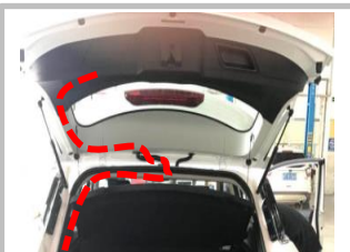
3.3 正极走线，顺着车身到主驾 A 柱侧面保险盒；驱动盒线到尾箱左侧
